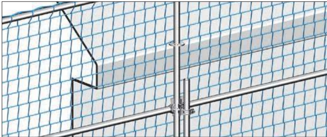
Kuva 149: Kaiteen suojaverkko, joka kiinnitetään pikaliittimillä
