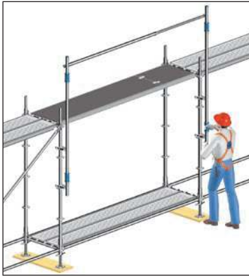
Kuva 14: Asennuskaiteen käyttö nousutiekentässä
