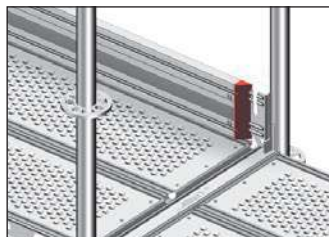
Kuva 50: Teräksisen jalkalistan asennus
