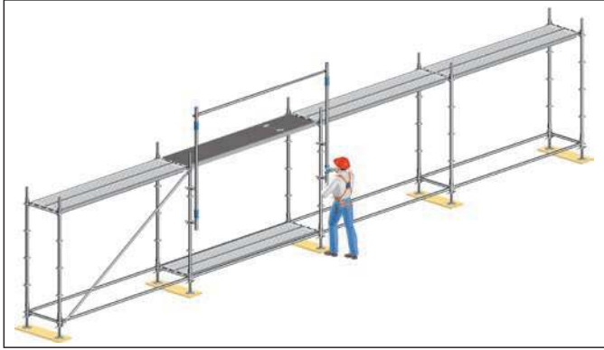
Kuva 14: Asennuskaiteen käyttö nousutiekentässä
