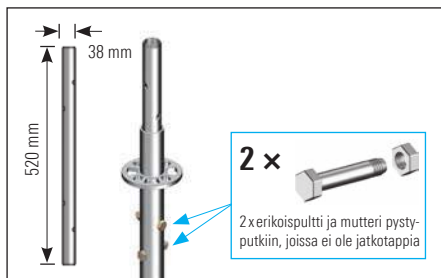
Kuva 31: Jatkotapin kiinnitys kahdella erikoispultilla M12 x 60 ja muttereilla
