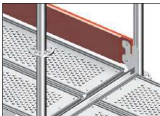
Kuva 49: Puisen jalkalistan asennus
